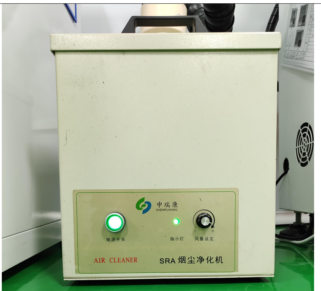
图 3.1-5 迁建项目废气处理设施（烟尘净化机）图片
